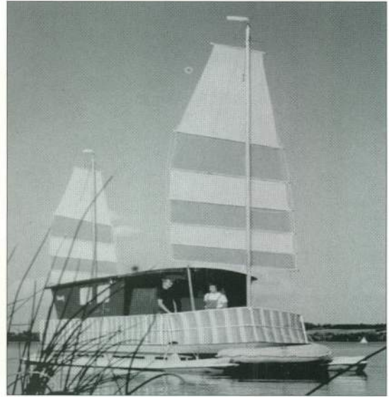
Ein 10 Meter langer und 3,5 To schwerer Motorkatamaran mit Dschunken Segel. von 1960 bis 1981 Eigner: Wolfgang Bohm
